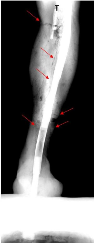
*Radiographie d'une sculpture en plâtre (Musée Auguste Rodin, Paris). Mise en évidence d'une armature métallique verticale dans la jambe gauche composée de tiges filetées, non jointives, reliées entre elles par des manchons. Des fissures sont détectées à la base du mollet, le long de la tige et au niveau du genou (flèches). Cette dernière est consolidée par un tenon métallique (T).*
